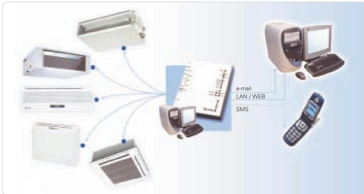
**Configuration de base :** 1 module passerelle de communication Airconet par site pouvant gérer jusqu'à 247 unités intérieures, 1 MIU par unité intérieure selon le type d'unité, 1 Repeater pour 50 MIU ou par étage.
