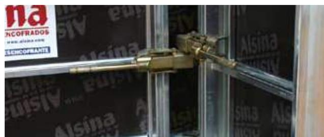
Le système Alisply Manual ainsi que ses accessoires, sont conçus pour un montage rapide et facile. L'appui du cadre de 15 cm facilite l'assemblage et l'alignement des panneaux. L'agrafe Alisply Manual permet l'assemblage en n'importe quel point du bâti ainsi que l'alignement des panneaux.
