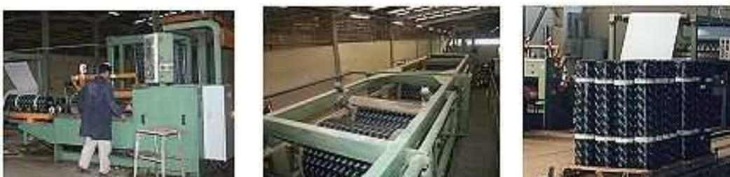
Enfin, un film très fin de polyéthylène enduit la face libre de la membrane alors que son autre face est tapissée de sable fin, de granulés colorés ou encore protégée par un feillard d'aluminium.
