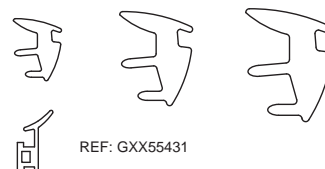
JUNTAS EXTERIOR ACRISTALAR JOINT DE VITRAGE EXTERIEUR
